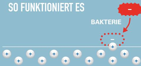
Wenn eine Bakterie mit den Silber-Ionen des Spacers in Kontakt kommt, verhindern diese das Wachstum und die Vermehrung der Bazillen. Die Gefahr einer Bakterienbesiedlung wird dadurch deutlich verringert.
