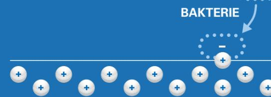
Wenn eine Bakterie mit den Silber-Ionen des Spacers in Kontakt kommt, verhindern diese das Wachstum und die Vermehrung der Bazillen. Die Gefahr einer Bakterienbesiedlung wird dadurch deutlich verringert.
